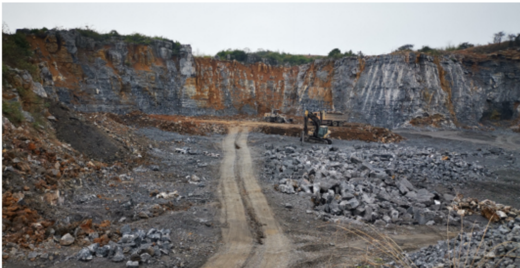
照片 1-2 矿山废渣回填采坑
